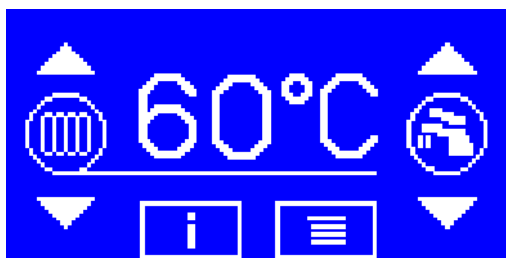
ОТОБРАЖЕНИЕ ТЕМП. ВОДЫ ОТОПЛЕНИЯ
